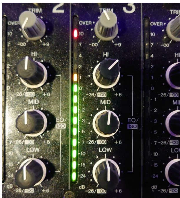
Photo 6 : Dépassement du niveau maximal (lumière rouge à l'indicateur +10dB)
