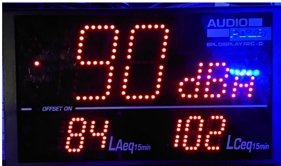
Photo 10 : Indicateur du niveau acoustique en cours (limiteur acoustique).
